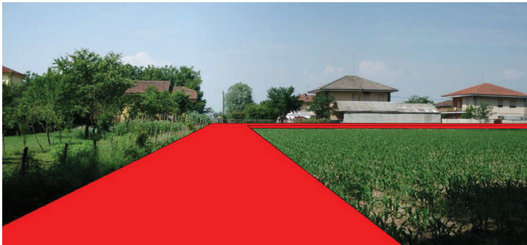
Figura 4-15 Vista della sponda sinistra a valle del ponte sulla SP30 con evidenziato il percorso della difesa arginale (rosso)
